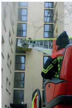
Tag 3: Die erste Übung musste im Unterflurbereich gefahren werden. Das bedeutet, die Einsatzstelle befindet sich unterhalb des Fahrzeugniveaus. Die engen und nicht ebenen Wege im Sportpark machten die Platzierung der Drehleiter und die Abstützung dabei zur Herausforderung.
