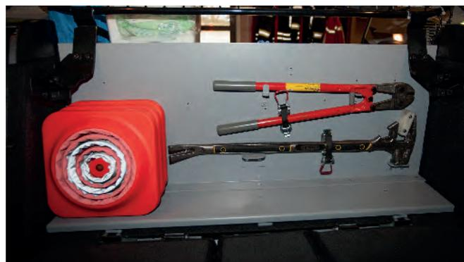
*Ausbau hinter der Rückbank mit Spezialwerkzeug und Verkehrsleitkegeln*
