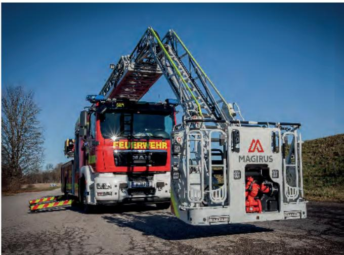
Blick auf den Rettungskorb mit eingebautem Wasserwerfer
